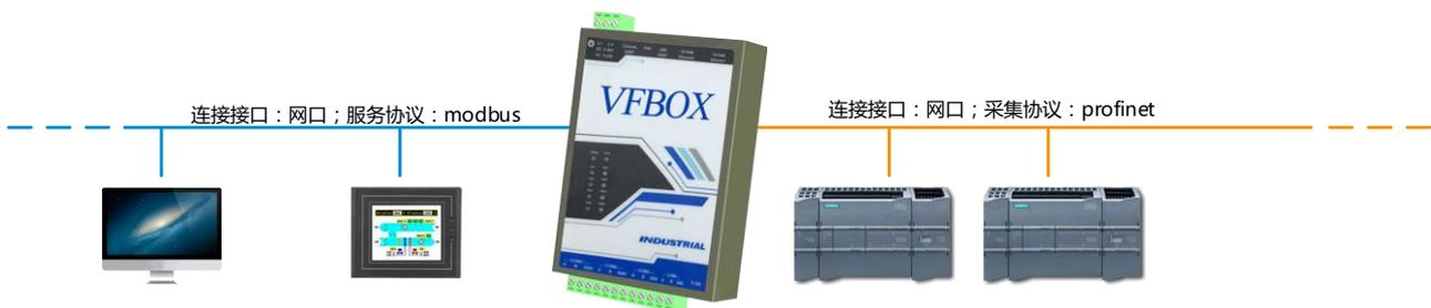
小结：在使用 VFBOX 网关的时候需要先了解被采集数据的设备有哪些连接接口，支持那种通信协议。
