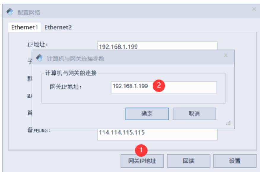
7. 在下图中输入新的 IP 地址。如果是两个网口的设置，则输入的两个网口的 IP 不能在同一个网段。如果不需要上因特网，只在局域网中使用，“网关”，“DNS”处可不用设置。
