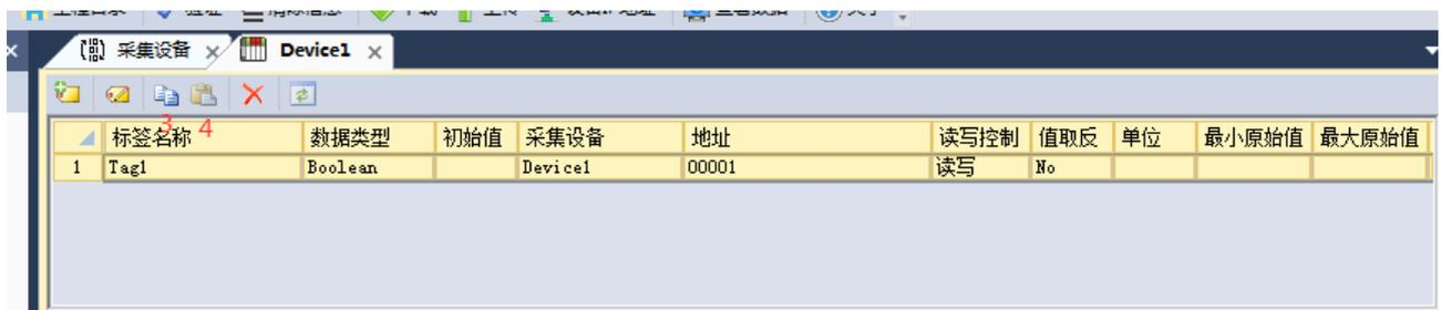
9. 如果要采集多个设备的数据，则继续点击“新建设备”来增加设备。以上过程完成了网关使用的采集协议，采集的点位等配置。以同样的方式可以配置其他类型的设备。
