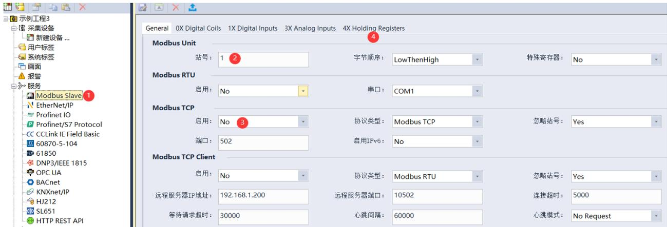
3. 点击下图中所示 (1)，进入上报数据设置，点击 (2) 弹出数据标签设置，在 (3) 处进行选择，选择完成后点击 OK 进行保存，然后点击 (4) 进行工程保存。
